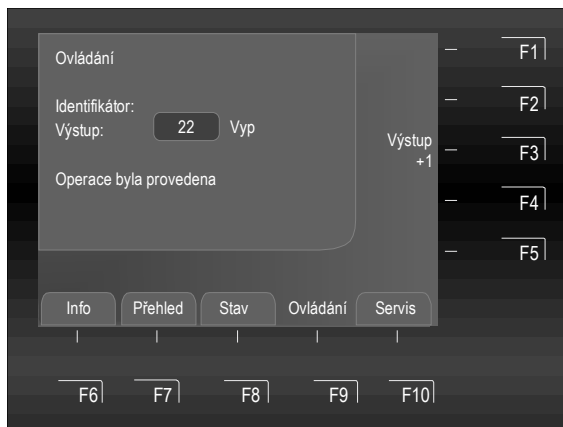
Obr. 70: Potvrzení odpojení výstupu 22
