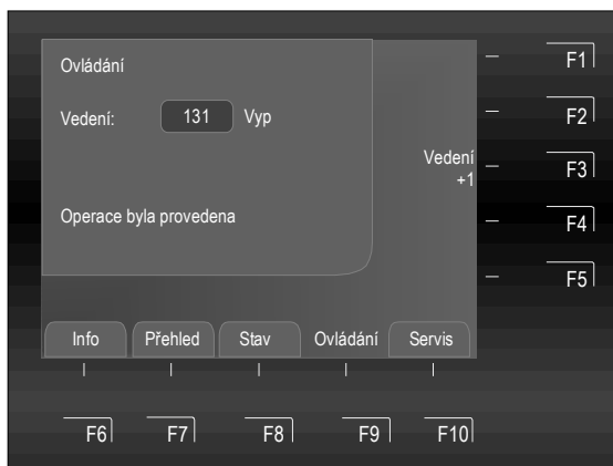
Obr. 80: Potvrzení odpojení vedení 131
